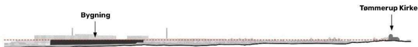
Figur 6: Snitdiagram som viser del af sigtelinjen mellem Tømmerup og Årby Kirke. Sigtelinjen er i 23.20, og på diagrammet ses bebyggelsen i kote 23.20 (DVR90). Overkanten af bebyggelsen holder sig under sigtelinjen.
